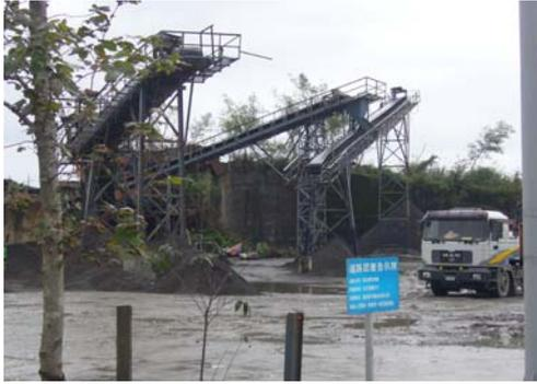
圖 6 粗細骨材之分類
