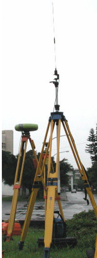
圖 5、RTK 基站之測量儀器
