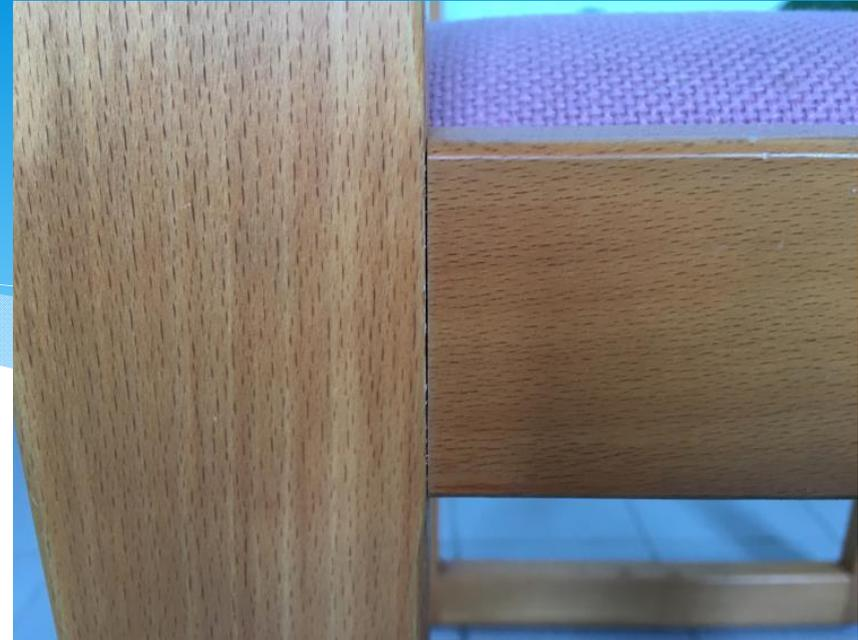
山毛櫸(*Fagus* spp., Beech) , 木材為重、硬、強，具有高衝擊抵抗力，適合做蒸氣彎曲加工，性質優良適合做家具使用。
